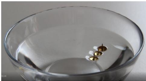
在玻璃碗中加满水，将三枚图钉小心地平放在水面上，针尖朝上。
